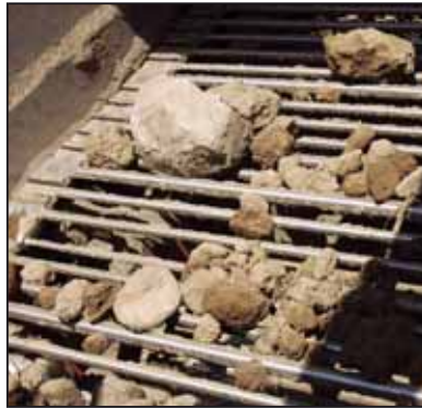
Hver sjette kædestang har en diameter på 16 mm, øvrige 11 mm. Det har tre afgørende fordele: Transporten af materialet på jorkkæderne optimeres, knolde kan bedre brydes og jorkkæden har en større stabilitet, der gør det muligt at transportere større sten.
