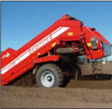
Alle modeller er standard udstyret med et frælægningsbånd med en deling på kun 22 mm (12 mm lysning).
