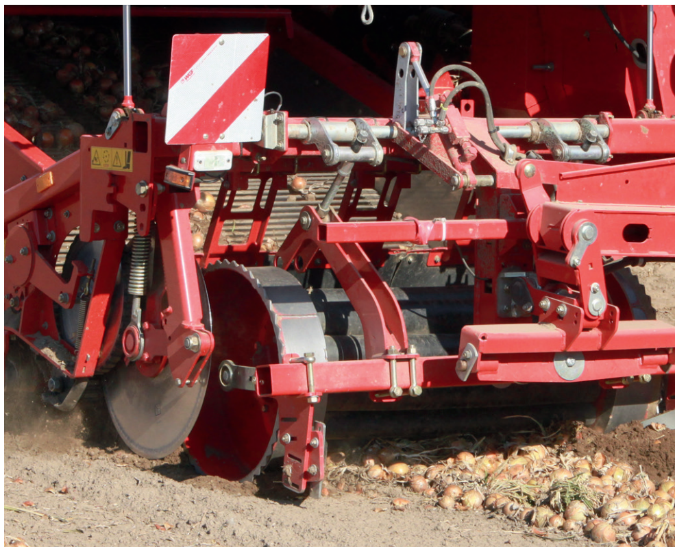
Tromleindføring - det takkede jernhjul fungerer som dybdestyring og samtidig sikrer det at tromlen drejer rundt og ikke "doser" kartoflerne (eller løg) foran sig.
