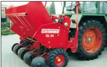
GL 34 KL: Kartoffellægger, 4-rækket, liftophængt, med tiptank
