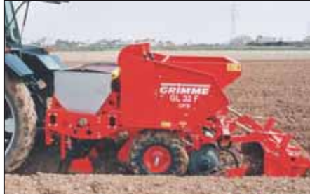
GL 32 F / GL 34 F: Kartoffellægger, 2- eller 4-rækket, liftophængt, med fast tank
