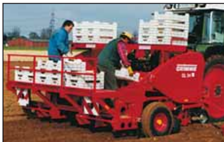
GL 34 RB: Kartoffellægger, 2- eller 4-rækket, liftophængt til forspirede kartofler
