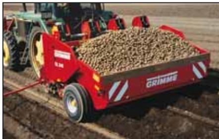
GL 34 K: Kartoffellægger, 4-rækket, liftophængt med stor tiptank
