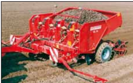
GL 34 T: Kartoffellægger, 4-rækket, bugseret med tiptank
