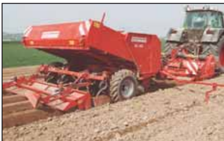
GL 34: 5 i 1-fræse-lægge-kombination, udfører op til 5 arbejds gange på én gang
