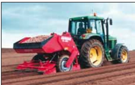
GL 32 B: Kartoffellægger, 2-rækket, liftophængt med tiptank, til strenglagte bede
