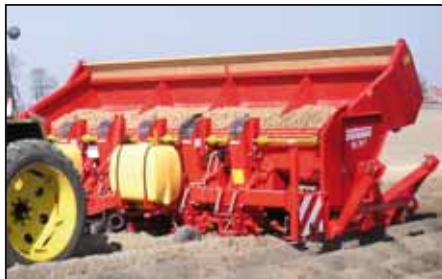
GL 36 T / GL 38 T: Kartoffellægger, 6- eller 8-rækket, bugseret med tiptank
