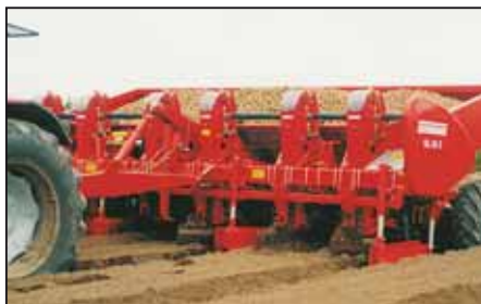
GL 34 B / GL 36 B: Kartoffellægger, 4- eller 6-rækket, bugseret med tiptank, til strenglagte bede
